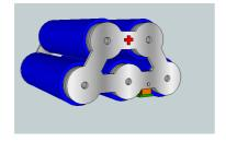
construção da bateria a partir de células individuais agrupadas em conjuntos de 5 e desenvolver um sistema de gestão de bateria distribuído dotado de uma rede de comunicações própria com isolamento galvânico, em que cada conjunto de 5 células é controlado por uma unidade
